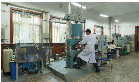
核电高温高压水腐蚀疲劳试验设备
