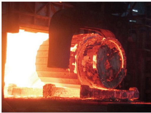
图2 热处理中的百吨级钢锭
