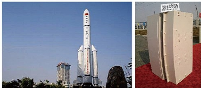
图3 微弧氧化防护后的长征火箭用镁质贯组支架
