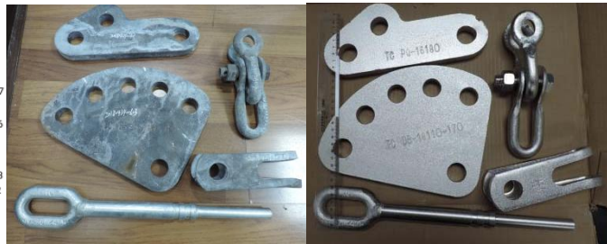
图10：系列金具耐磨减磨处理前后对比
